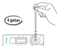
**5** Agregue 4 gotas de la mezcla en la ventana del dispositivo
